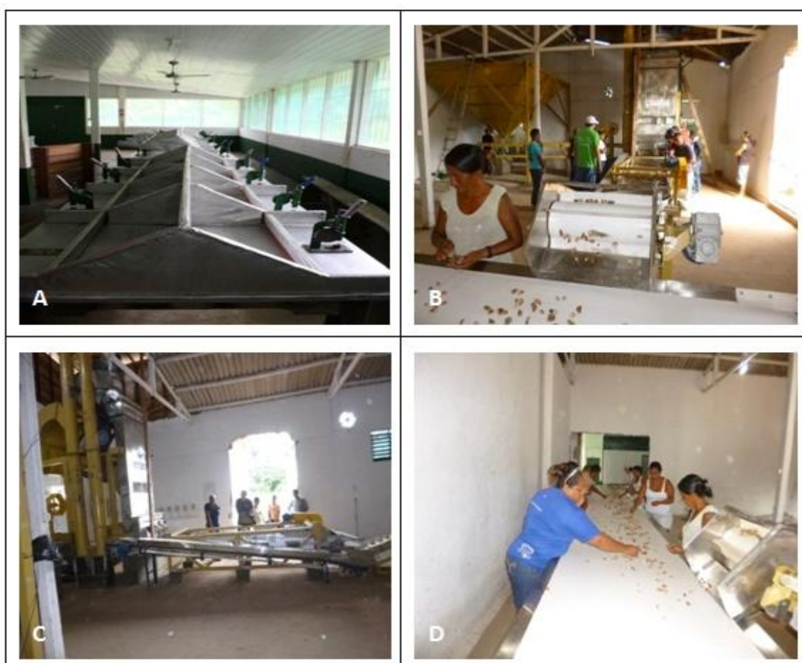
Figura 4. Sistema de quebra manual (A), Maquinário Implantando – quebra automatizada (B) e (C), novo posto das cooperadas em selecionar as amêndoas (D)
