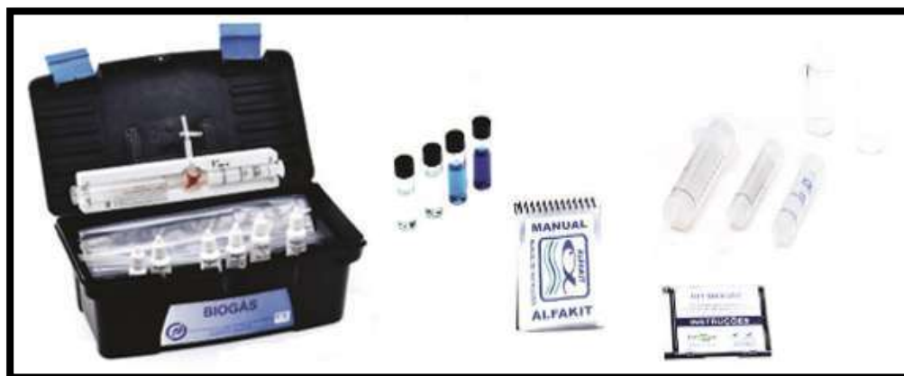
Figura 01. Materiais que compõem o kit do biogás. Fonte: ALFAKIT (2016).
