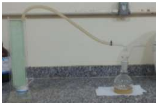
Figura 1: Sistema para captação de H 2 .
