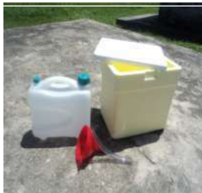
Figura 05. Material utilizado na coleta de água da chuva: Caixas de isopor, galão, funil e mangueira.
