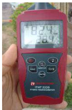
Figura 5: Termo higrômetro sendo utilizado para a leitura dos dados.
