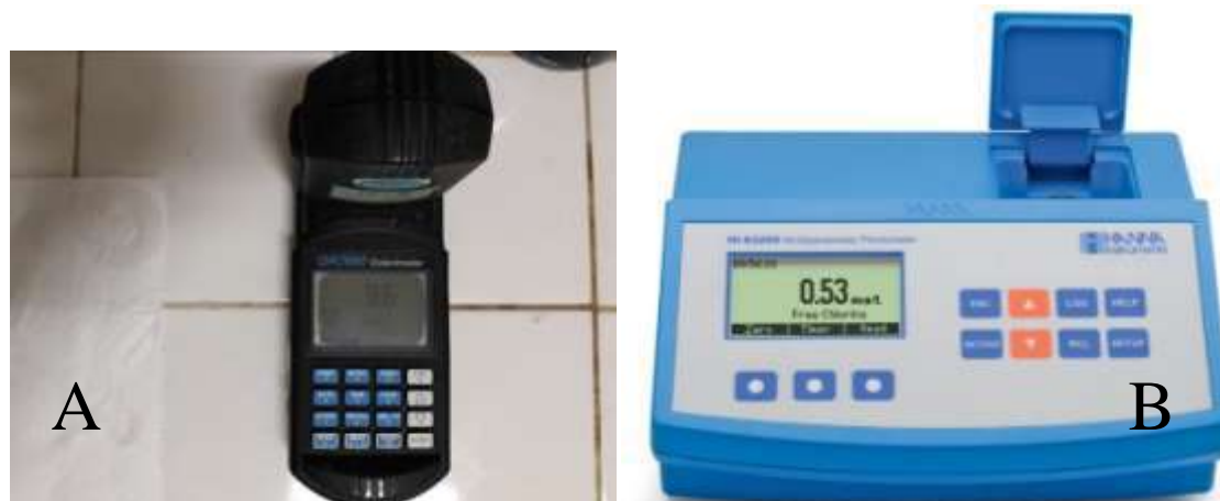
Figura 3: a) Colorímetro DR/890 utilizado para obter dados de sólidos em suspensão e turbidez, b) Espectrofotômetro.
