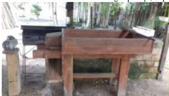
Figura 4 - Ralador de mandioca elétrico usado na Vila de Igarapé-Açu, Capitão Poço, Pará.
