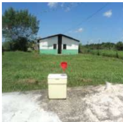
Figura 06. Instalação do coletor de águas pluviais em campo aberto próximo à suinocultura.
