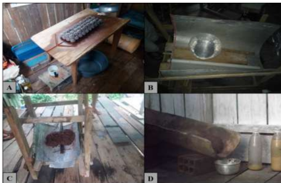
FIGURA 04. Forma de extração em superfície inclinada: (A) tábua; (B) e (C) formas de alumínio (D) telha de cerâmica. Diferentes formas da massa de andiroba: (A), (C) e (D) realizada pelos extratores do PAEX do Município de Igarapé-Miri
